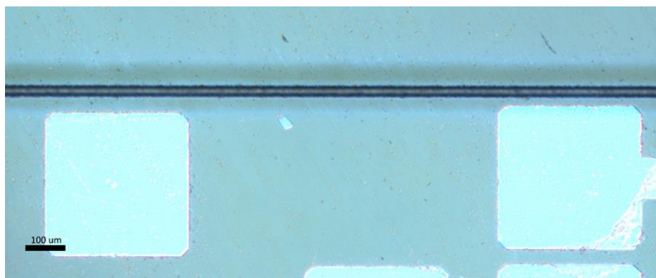
Рис. 85. Фотография реза между чипами. Абляционный режим. E_{\text{имп}}=2 мкДж, NA=0.39 , скорость сканирования 3 мм/сек.
