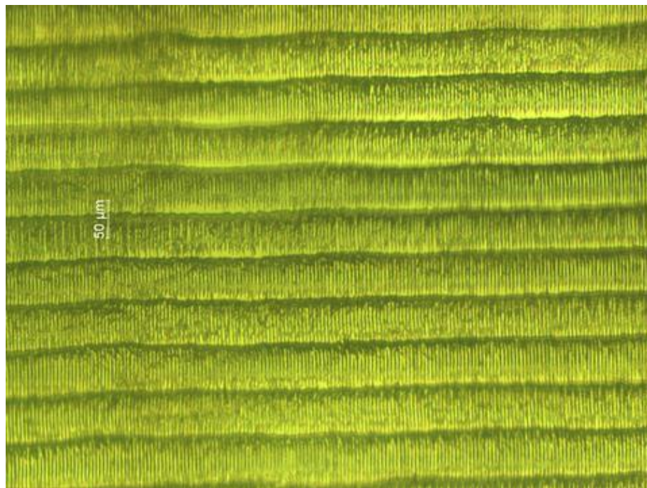
Рис. 75. Фотография поверхности реза. Многопроходная резка. Contamac Contaflex. E_{\text{имп}}=10 мкДж, V_{\text{ск}}=800 мкм/сек, f=200 Гц, N.A.=0.39 .
